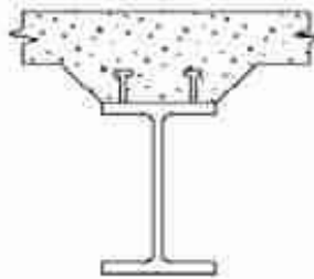
Losa reforzada en la zona de la unión con la viga
